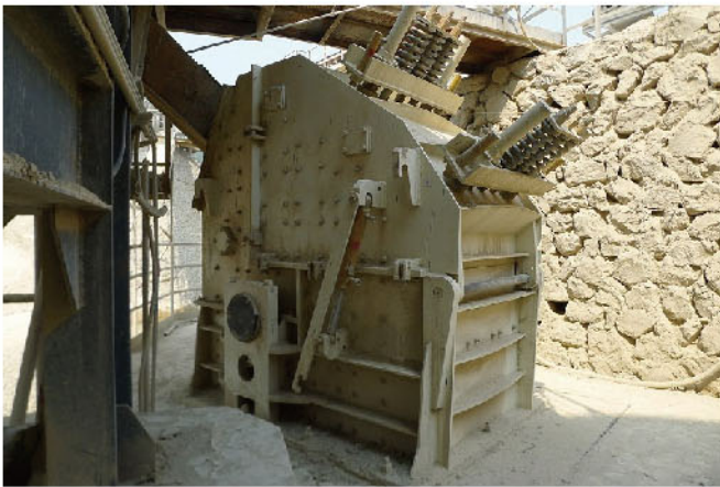
北京金隅水泥厂 HC-255 反击式破碎机 Beijing Jinyu cement plant HC-255 impact crusher
